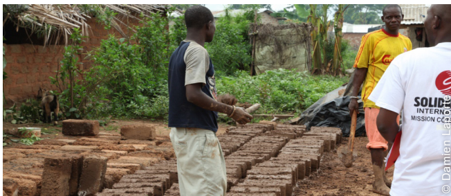
Séchage de briques en terre crue. (Niambly)
